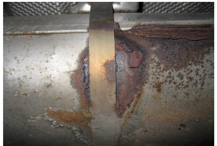
corrosie aan de achterste uitlaatdemper
