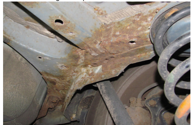
Foto roestvorming bodemplaat
