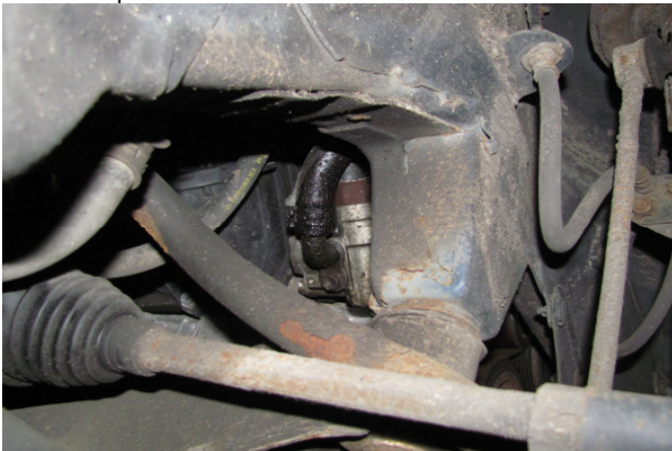
Foto oliesporen motor
